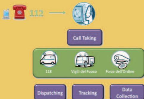
La gestione di una chiamata di soccorso avviene con un processo diviso in quattro fasi:
