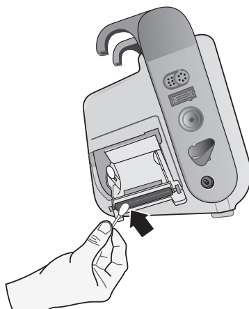
Figura 24-3. Pulizia della testina di stampa
