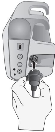
1. Inserire l'MFC nell'unità.
