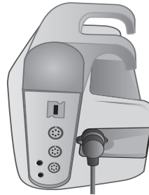
2. Connettore bloccato in posizione.
