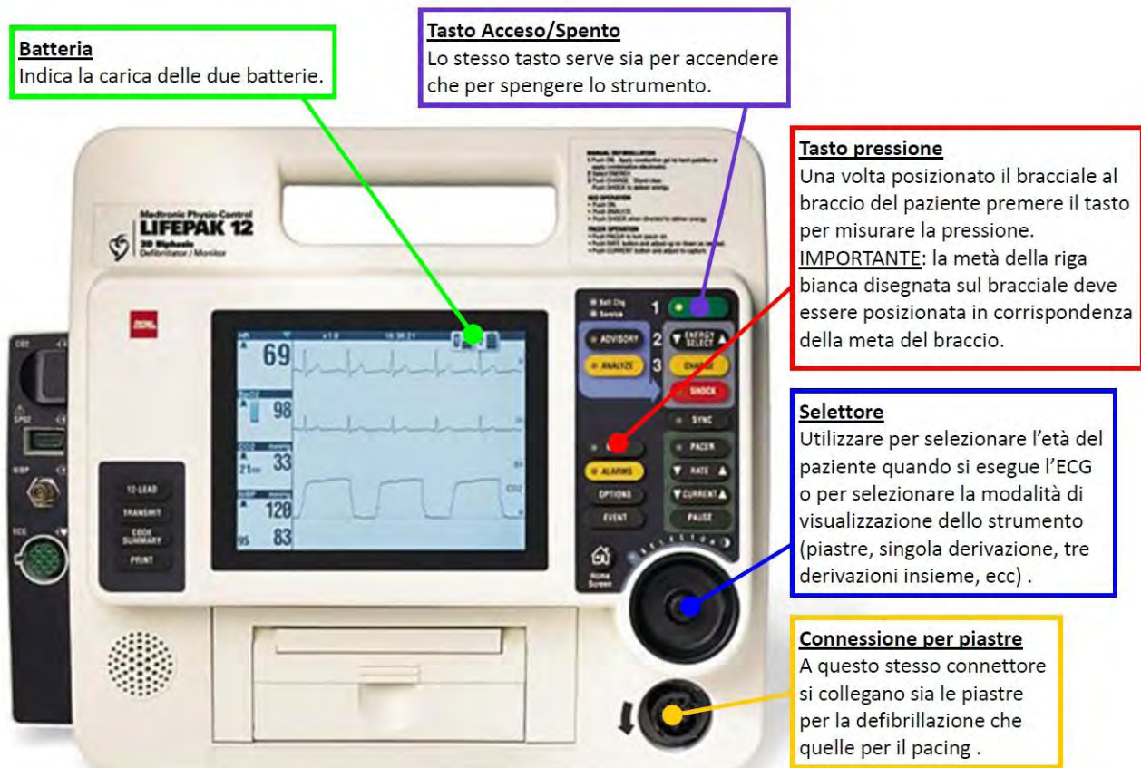
Figura 18. Lifepak 12, descrizione pulsanti e connettori lato destro.
